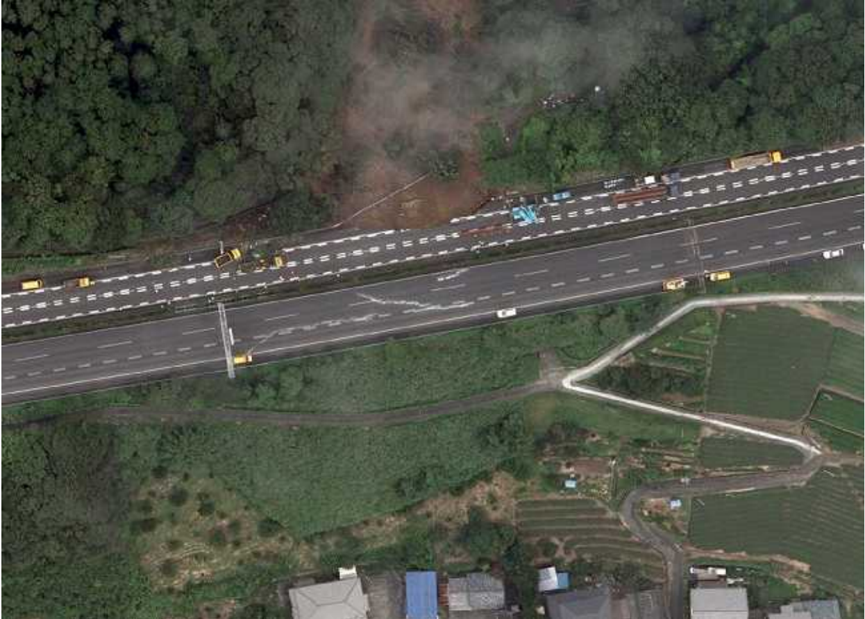
写真 4.1 東名高速道路、牧之原SA東方の上り車線の路肩崩壊写真(国土地理院)
